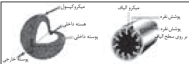
شکل ۷- نانوذرات نقره (a) تصویر ساختاری نانوذرات نقره حاوی میکروکپسول‌های کاربردی (b) مقطع عرضی الیاف پوشش دهی شده با نانوذرات نقره
